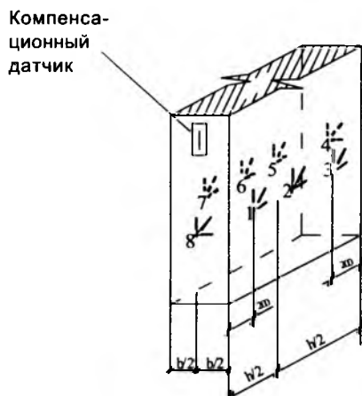
Рис. 1 Схема наклейки датчиков на колонны
