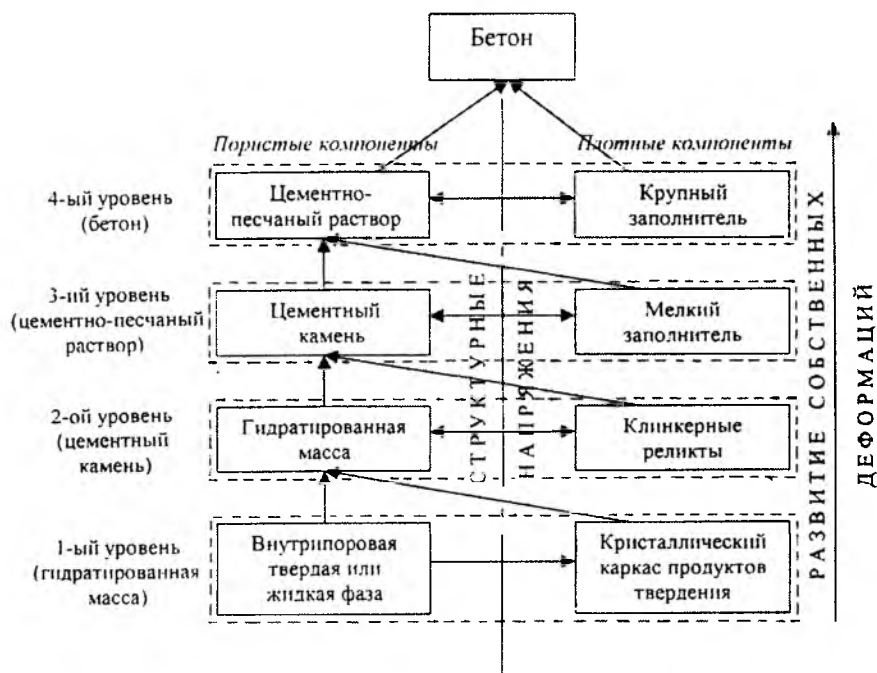
Рис.1. Схема развития процессов коррозии 3 вида в бетонном конгломерате
