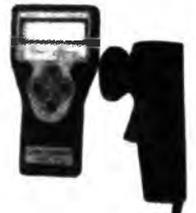
Измеритель прочности бетона, раствора, кирпича методом ударного импульса по ГОСТ 22690. Расширенный режим с возможностью учесть вид заполнителя, возраст и условия твердения бетона. Более 100 зависимостей.
