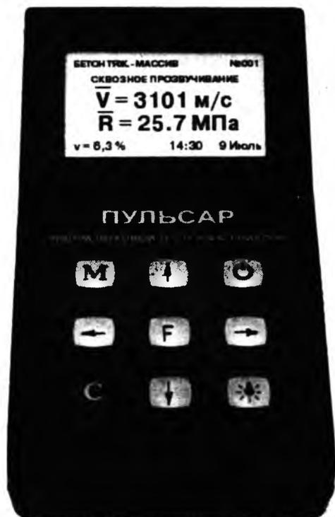
**ПУЛЬСАР - 1** - ультразвуковой измеритель прочности, плотности и модуля упругости монолитного и сборного железобетона, кирпича и др.. материалов
