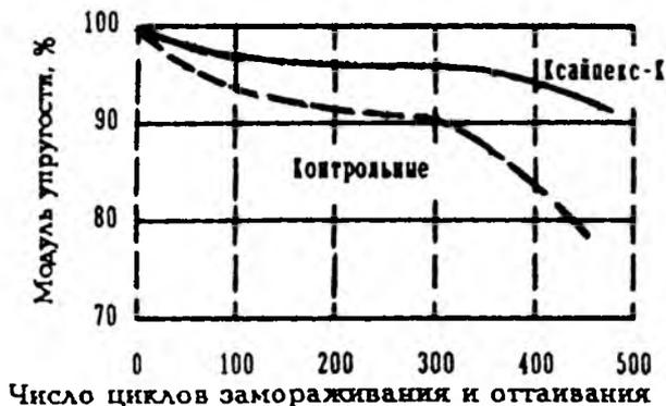
Рис. 2. Влияние обработки бетона Ксайпекс-концентратом на его морозостойкость
