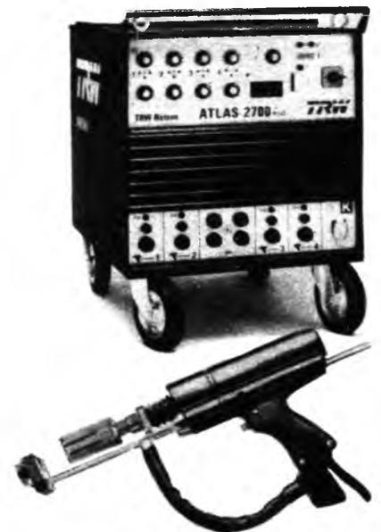
Рис. 1. Передвижной сварочный аппарат АТЛАС 2700 Плюс
