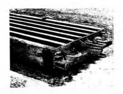
Рис. 1. Многоместная форма с упругоработающими элементами для изготовления преднапряженных бортовых камней длиной 6 м
