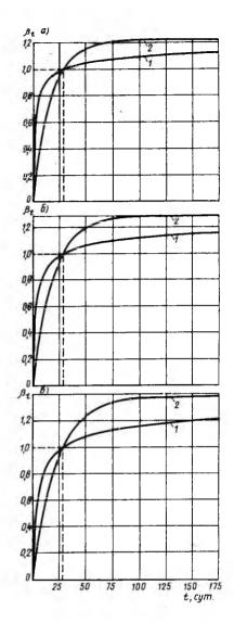
Зависимость  $\beta_t$  от t для бетона на высокомарочном (a), нормальном (b) и медленнотвердеющем цементе (b) 1 — по (3); 2 — по (8)
