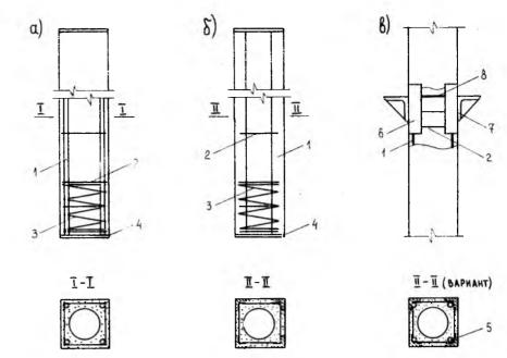
Рис. 1. Конструктивные решения колонн пустотного сечения a — армирование стержневой продольной арматурой;  $\delta$  — то же внешней продольной арматурой из прокатных профилей; в --- сопряжение металлических консолей со стволом колонны; I — продольная арматура; 2 — поперечная арматура; 3 усиление концевых участков спиралью; 4 — торцевая пластина; 5 ная продольная арматура; 6 — закладная деталь или внешняя продольная арматура; 7 — металлическая консоль; 8 — соединительный стержень
