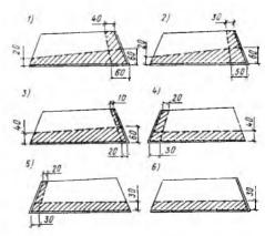
Рис. 3. Схемы наплавки лопастей
