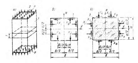
Рис. 1. Сталебетонный элемент (a), расчетные схемы обоймы (б) и ядра (в)
