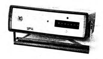
УСТРОЙСТВО ДЛЯ АВТОМАТИЧЕСКОГО УЧЕТА РАСХОДА ЦЕМЕНТА подключается к дозировочно-смесительным узлам и установкам периодического действия, оснащенным дозаторами АВДЦ—1200М, АД—600—2БЦ (ДБЦ—600) и аналогичными.
