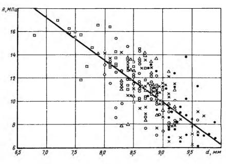
Рис. 1. Градуировочные зависимости для бетона в возрасте 2 сут при использовании методов: ультразвукового способом поверхностного прозвучивания (a), упругого отскока (b), пластических деформаций при ударе (a), то же при вдавливании (a) и ударного импульса (d)
