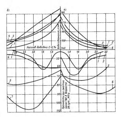
Рис. 2. Влияние дозировки суперпластификатора С - 3 на водосодержание бетонных смесей и прочность бетона после ТВО в возрасте 28 сут при различных степенях наполнения при Ц=400 кг
