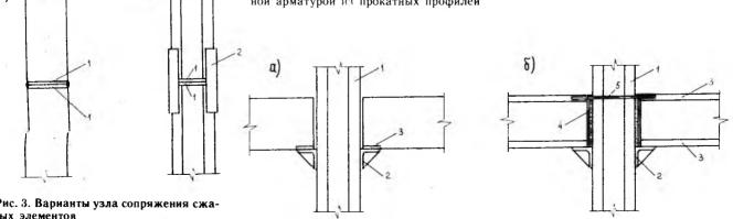
Рис. 3. Варианты узла сопряжения сжатых элементов
