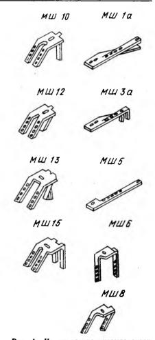
Рис. 1. Номенклатура штампованных закладных деталей
