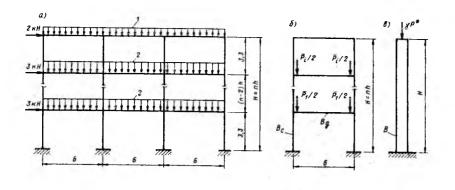
Рис. 1. Определение критической силы для железобетонных рам
