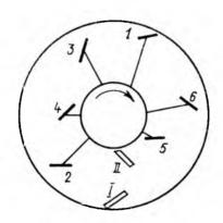
Рис. 1. Схема расположения лопастей (1...6) и скребков (I и II) в чаше смесителя
