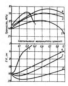
Рис. 1. Влияние дозировки наполнителей при постоянном расходе цемента (400 кг), воды (165 л) и суперпластификатора С — 3 (1 %) на подвижность бетонных смесей и прочность бетона после ТВО
