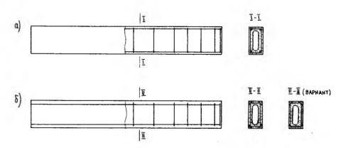
Рис. 2. Конструктивные решения изгибаемых элементов пустотного сечения
