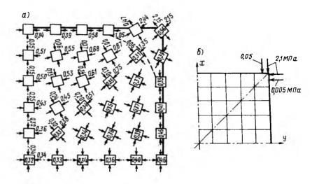
Рис. 2. Распределение напряжений по главным площадкам (а) в сечении элемента в предельном состоянии при взаимодействии оболочки и ядра в углах сечения (б) 0,32 — коэффициент поперечных деформаций; —.— линия, ограничивающая зону растягивающих напряжений
