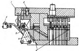
Рис. 2. Штамп для изготовления закладной детали МШ-10
