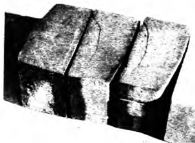
Рис. 3. Распилы бордюрного камня на песке с M_k=1,7
