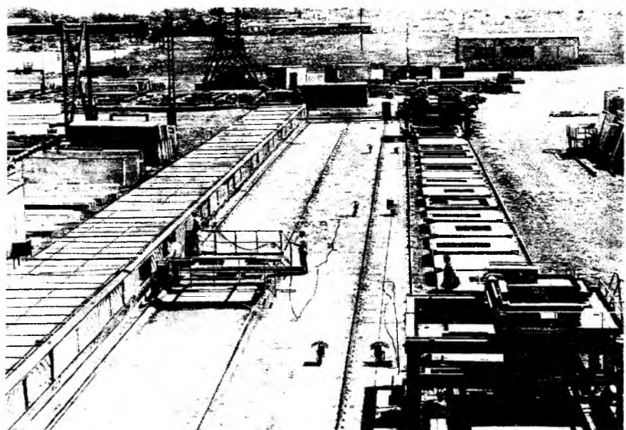
Рис. 6. Технологическая линия с индивидуальными тупиковыми камерами шелевого типа на ССК № 3 в пос. Солдатский (Ташкентская обл.)
