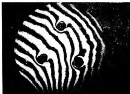
Рис. 6. Интерференграмма образца при жестком состоянии системы заполнителей
