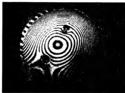
Рис. 5. Интерференграмма образца при свободном состоянии системы заполнителей
