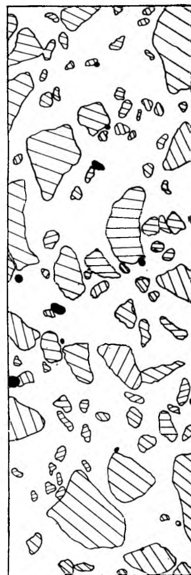
Рис. 3. Зарисовка-развертка керна, выбуренного из нижней части свай на глубине 25,7 м
