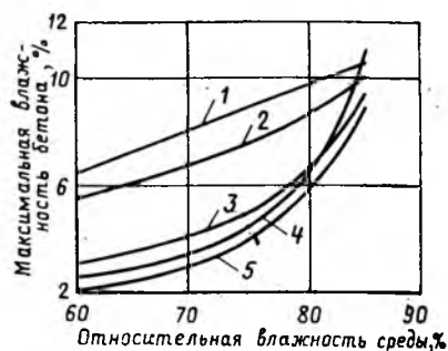
Рис. 2. Расчетная эксплуатационная влажность бетона в ограждающих конструкциях из 1 — бетона на вулканическом шлаке Кармрашенского месторождения; 2 — керамзитобетона; 3 — шлакопемзобетона с добавкой шлама и СДО; 4 — шлакопемзобетон с добавкой шлама; 5 — шлакопемзобетона
