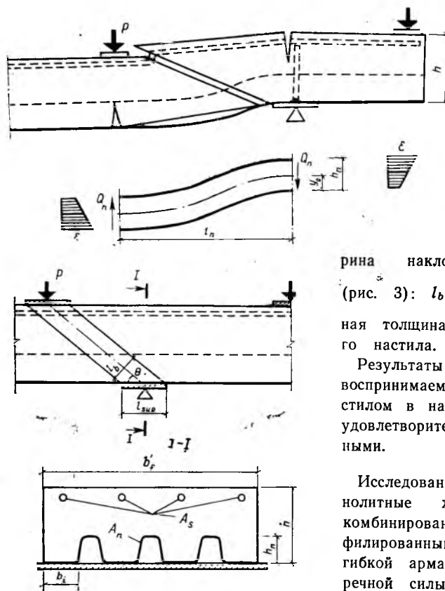
Рис. 3. Схема расчета прочности плит с профилированным настилом по наклонной сжатой полосе
