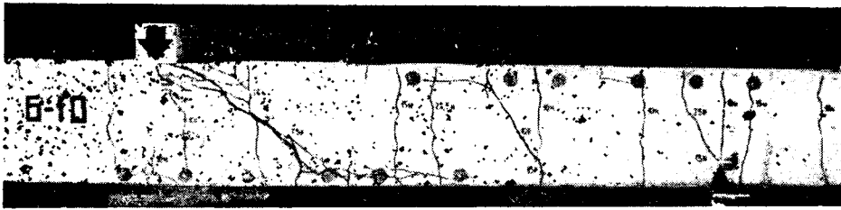
Рис. 2. Характер трещинообразования и разрушения балки при двузначной эпюре изгибающих моментов в зоне действия поперечных сил и продольных растягивающих сил
