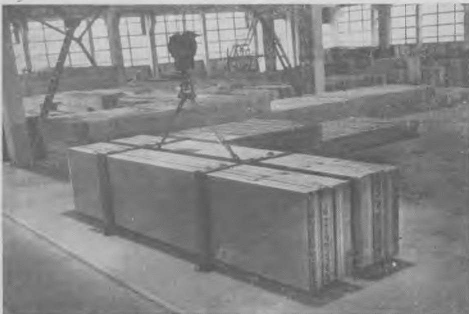
Рис. 1. Мелкие блоки и панели из ячеистого бетона марки М35 плотностью 600 кг/м 3 на складе готовой продукции
