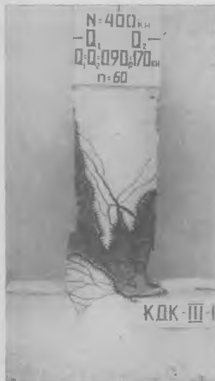
Рис. 2. Общий вид разрушившихся образцов после испытания знакопеременной динамической нагрузкой
