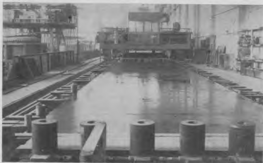
Рис. 1. Робот-манипулятор для механизированной намотки канатной арматуры (намоточная машина 6540)
