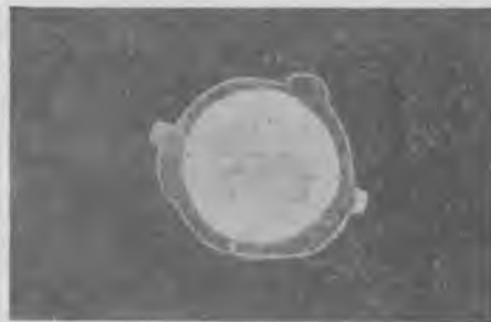
Рис. 2. Структура термомеханически упрочненных арматурных стержней ( \sigma_{0.2} \geq 600 Н/мм 2 )
