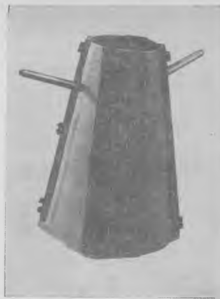
Рис. 2. Общий вид конуса для определения подвижности разогретой бетонной смеси
