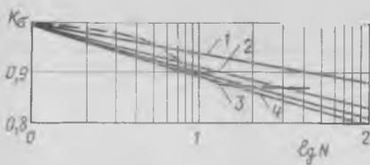
Рис. 1. Изменение  $k_{\sigma}$  в зависимости от расчетного числа циклов нагружений
