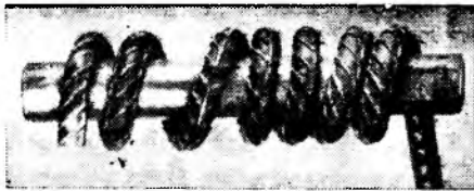
Рис. 5. Холодный загиб в спираль вокруг оправки диаметром 2,5d арматуры диаметром 10 мм из стали 10ГС2 ( \sigma_B = 1250 МПа)
