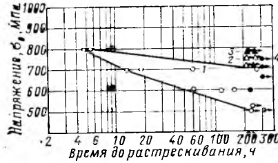
Рис. 2. Стойкость против коррозионного растрескивания под напряжением арматуры из стали 10ГС2, термически упрочненной в процессе прокатки ( \sigma_B=1200-1250 МПа) 1, 3, 4 — соответственно \varnothing 10 , \varnothing 14 и \varnothing 18 мм, периодического профиля; 2 — \varnothing 10 мм, гладкая
