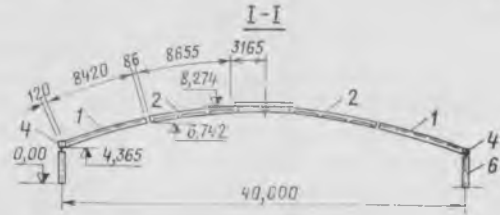
Рис. 3. Членение оболочки на сборные элементы и монолитные участки
