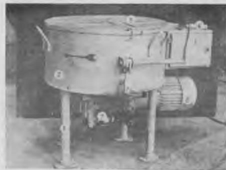
Рис. 3. Бетоносмеситель СБ-142
