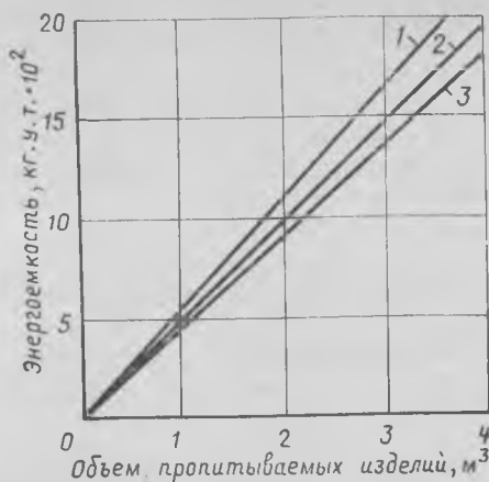
Рис. 3. Зависимость энергоемкости технологии пропитки от вида пропитки 1 — поверхностная; 2 — частичная; 3 — полная
