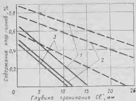
Рис. 2. Распределение хлоридов по сечению образцов из цементно-песчаного раствора различной плотности в условиях действия пыли полиминеральной руды (—) и атмосферных осадков (---) 1 — W/C=0,6 ; 2 — W/C=0,5 ; 3 — W/C=0,4
