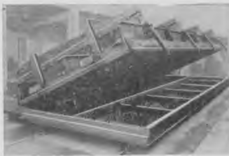
Рис. 1. Установка с отформованной ребристой плитой
