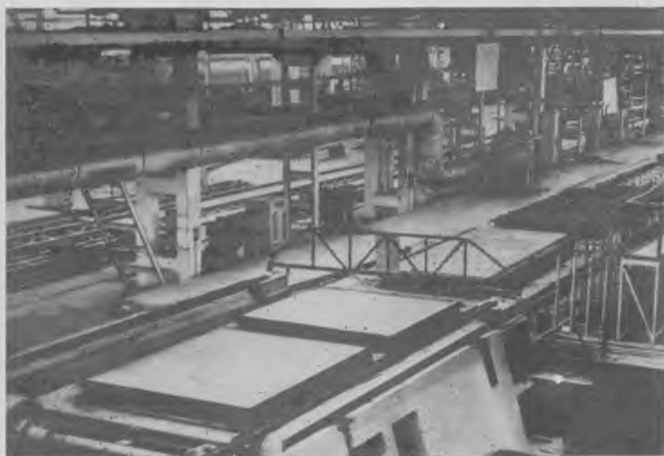
Рис. 1. Общий вид конвейера (на переднем плане — платформа-вагонетка с двумя формами на подъемнике)
