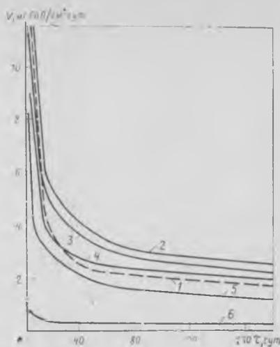
Рис. 2. Кинетическая зависимость  $V = f(t)$  коррозии цементного камня в растворах серной кислоты различной концентрации
