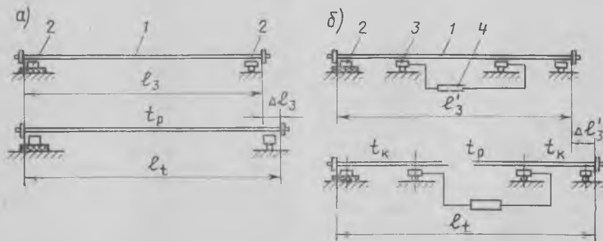
Схема расстановки электроконтактов при нагреве арматурных стержней традиционным (а) и предложенным (б) способами
