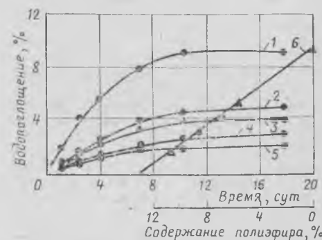
Рис. 2. Зависимость водопоглощения бетонополимеров с различным содержанием ненасыщенных полиэфиров (1—5) от времени выдерживания в воде и максимального значения водопоглощения от содержания полиэфира в бетонополимере (6)
