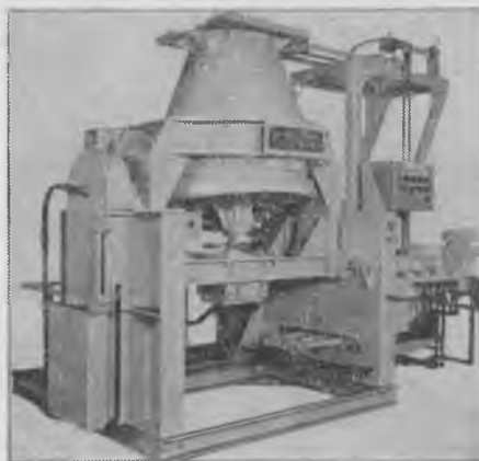
Рис. 2. Общий вид смесителя фирмы «Chijoda» с объемом готового замеса 150 л
