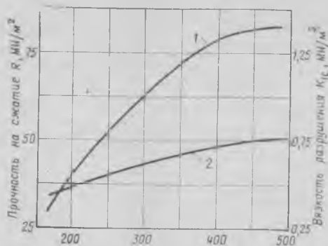
Рис. 2. Характер изменения вязкости разрушения K_{1с} (1) и прочности цементного камня R (2) от активности цемента
