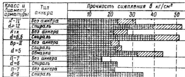
Рис. 4. Сравнительная диаграмма прочностей сцепления ячеистого бетона
