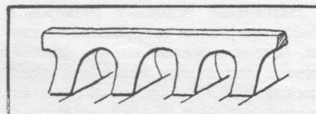
эти плоскости могут или совсем отделяться от основной плоскости (например стена с контрфорсами) или составлять с ней одно неразрывное целое (арочный мост с наклонными фермами).
