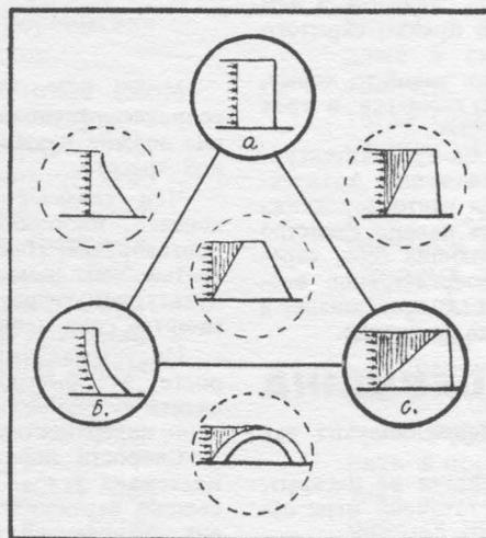
этим основными формами имеется ряд промежуточных, которые в одном и том же сооружении дают частичное использование двух или трех основных идей.
