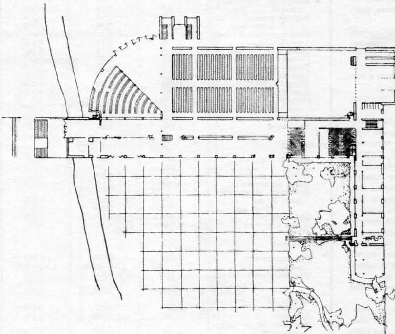
Принятая схема плана дает возможность правильно и равномерно эксплуатировать здание как театр и как кино. В фойе боковая наружная стена раздвигается, расширяя тем самым емкость помещения за счет прилегающего участка сада. Сцена имеет открытую арку как в зрительный зал, так и в сад. При верхнем фойе для ожидающей публики устроена читальня. Сильный уклон местности обусловил решение участка
