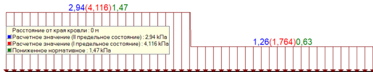
Снеговая нагрузка при учете переноса снега с высотной секции (справа) на низкую (слева)
