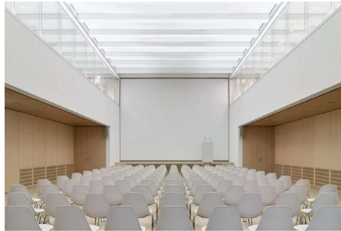
Визуальный дизайн подчинен акустике. Крупные элементы отделки стен выполняют роль акустических диффузоров или поглотителей
