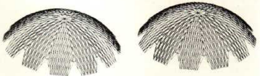
Рис. 6. Стереопара перспективного вида купола, выполненная графопостроителем
