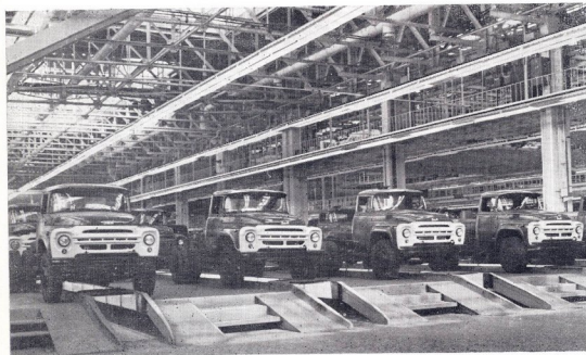
Автоборочный корпус. Пролет отделочного конвейера
