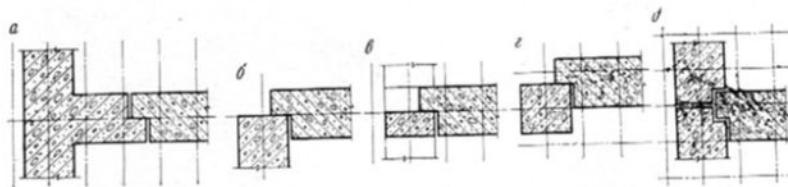
Конструктивные узлы единого каталога конструкций А-71 зданий и сооружений научного городка Сибирского отделения ВАСХНИЛ, разработанного на базе положений модульно-регуляционной системы. Конструкции каталога обеспечивают необходимый научным объектам набор габаритов и нагрузок, вариантность пространственных и планировочных решений, составляют «открытую» систему, связанную с технологическим и инженерным оборудованием
