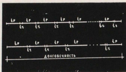
Рис. 3. Отрезки времени безотказной работы конструкции [элемента] на протяжении общего срока службы (долговечности) t_p — отрезки времени работы; t_r — отрезки времени ремонта
