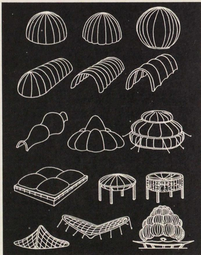
РИС. 8. РАЗЛИЧНЫЕ ФОРМЫ ПНЕВМАТИЧЕСКИХ КОНСТРУКЦИЙ
