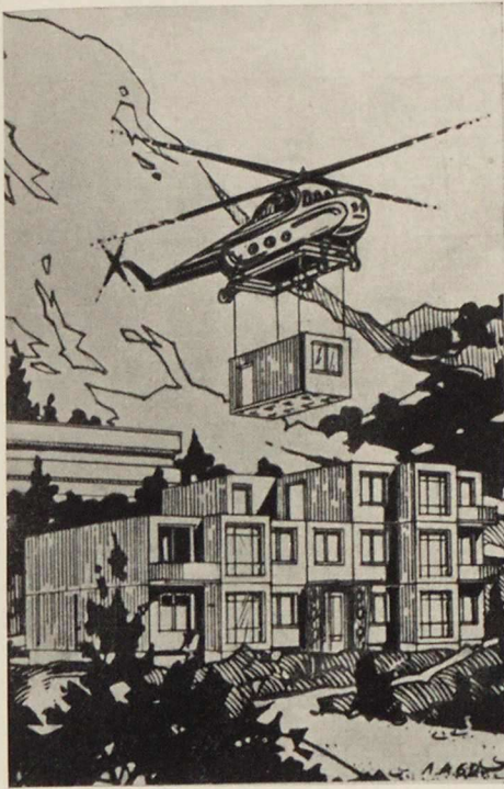
ВОЗМОЖНЫЙ МОНТАЖ ДОМА ИЗ БЛОК-КОМНАТ ВЕРТОЛЕТОМ
