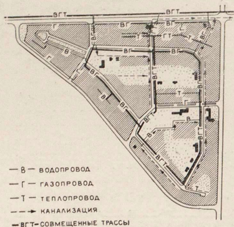
Пример размещения подземных сетей в жилом районе
