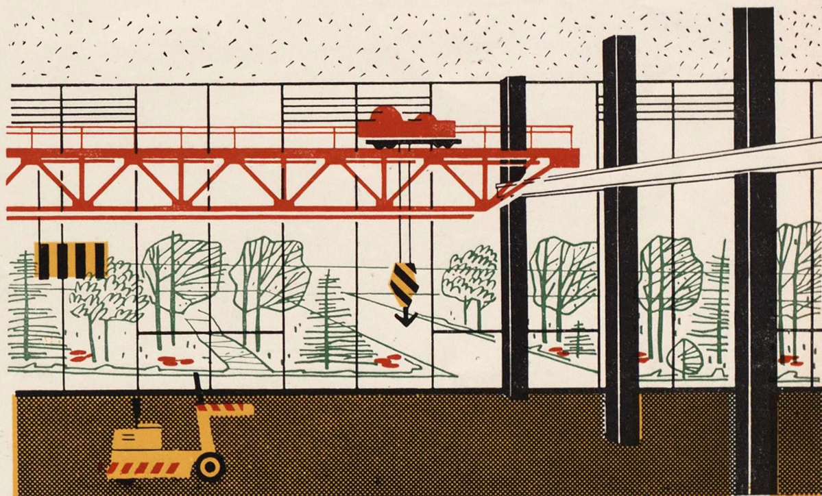
Функциональная окраска в интерьере промышленных зданий
