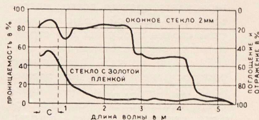
Рис. 2. Спектральная пропускательность обычного и теплоотражающего стекла с золотой пленкой. С — видимая часть спектра
