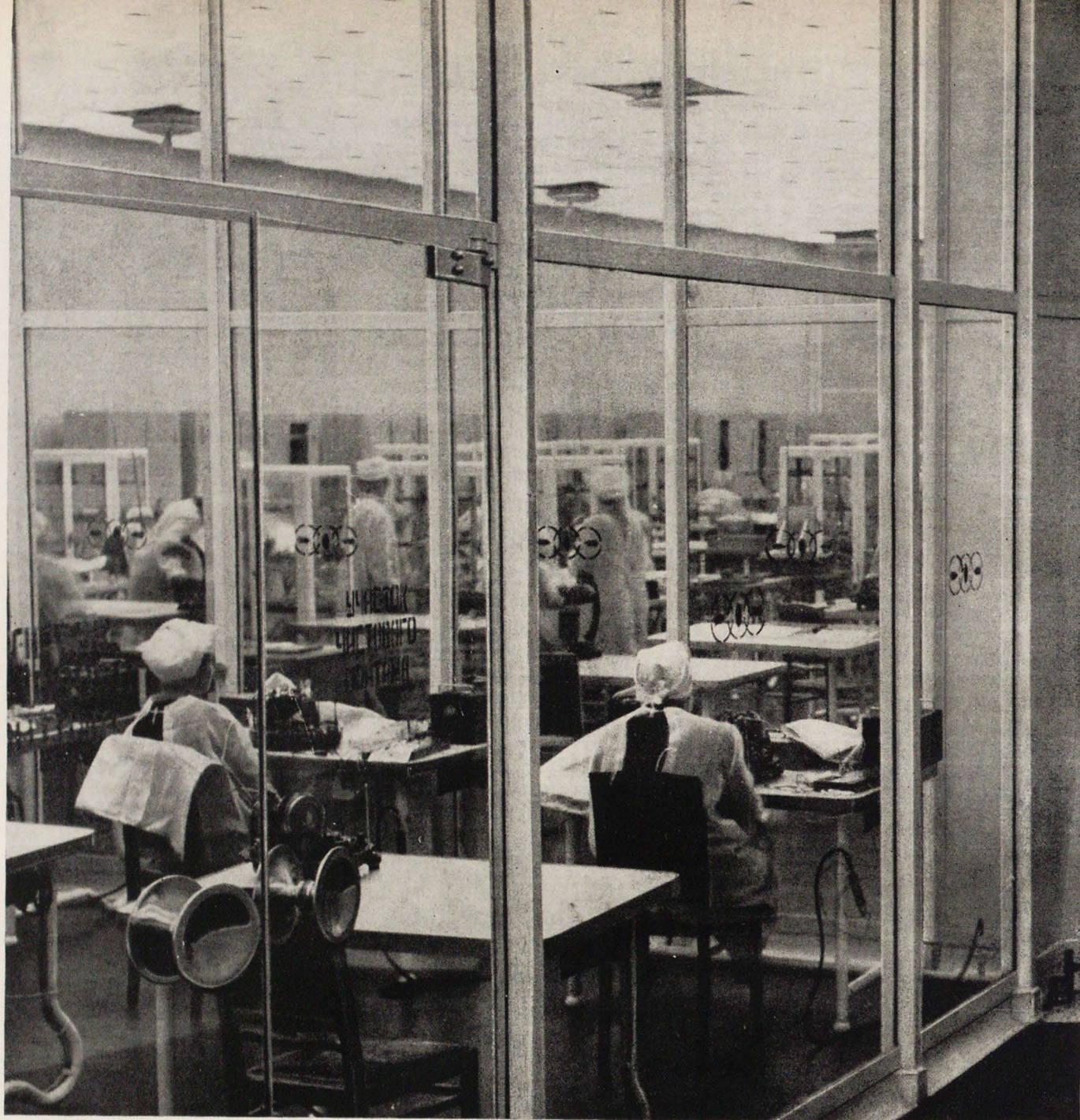
Один из цехов предприятий радиоэлектроники. Цех оборудован системами кондиционирования воздуха и удаления пыли. Температурно-влажностный режим помещения регулируется автоматически. Пространство цеха разделено сборно-разборными перегородками и освещается рассеянным светом люминесцентных ламп
