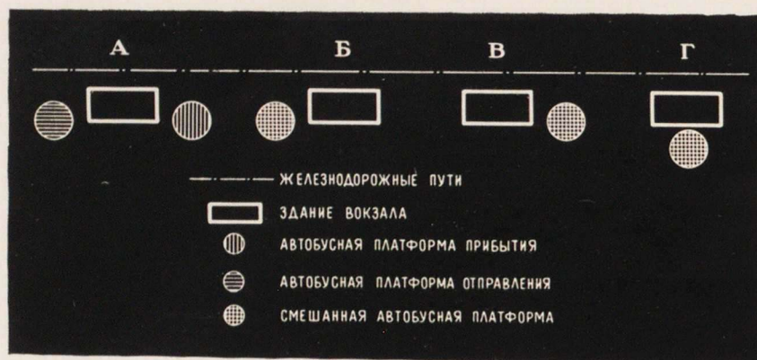
Рис. 3. Схемы взаиморасположения железнодорожных путей и платформ, здания вокзала и автобусных платформ (А — отдельные автобусные платформы; Б, В, Г — смешанные автобусные платформы)
