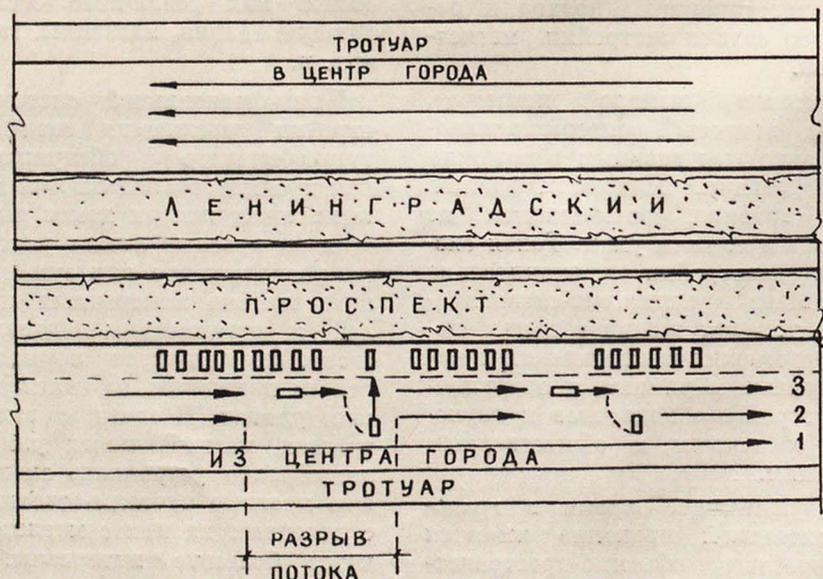
Схема загрузки машинами автостоянок у стадиона Динамо в Москве (по материалам М. И. Ерошевского)
