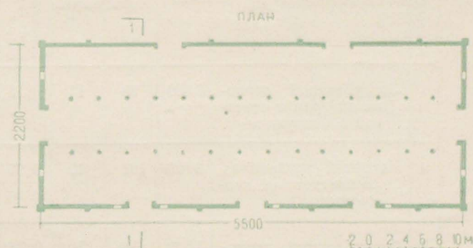
Напольное зернохранилище емкостью 2 000 т в колхозе «Сталинский путь», Крымского района, Краснодарского края
