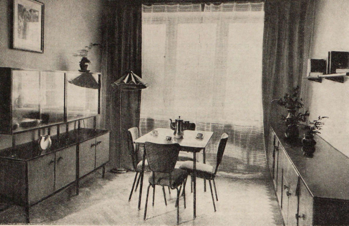
Сборная секционная мебель на металлических ножках. Стол и стулья имеют каркасы из тонкостенных стальных труб. Образцы разработаны САКБ Мосгорисполкома совместно с мебельной фабрикой № 1 Мосгорсовнархоза (третья премия). Справа на цветном фото — мебель детской комнаты
