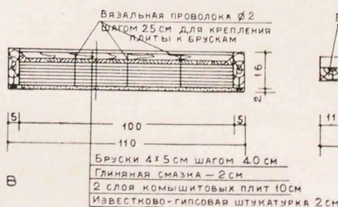
Конструкция гипсокамышитовых панелей
