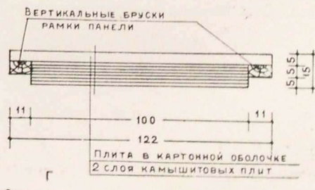
Конструкция гипсокамышитовых панелей
