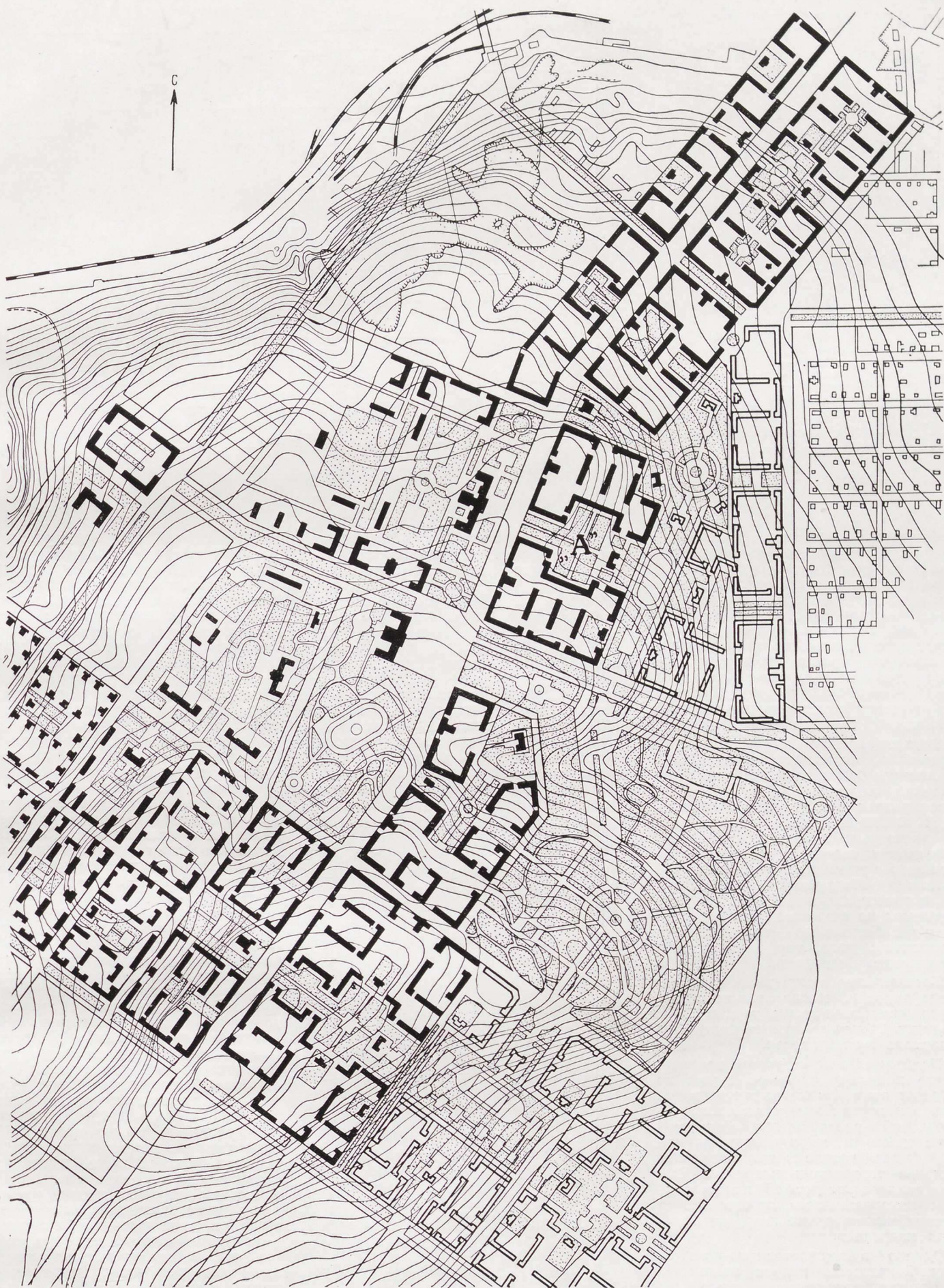
Схема застройки жилого района в Ярославле. Ради соблюдения симметрии, в планировке не учитываются рельеф местности и требования инсоляции квартир
