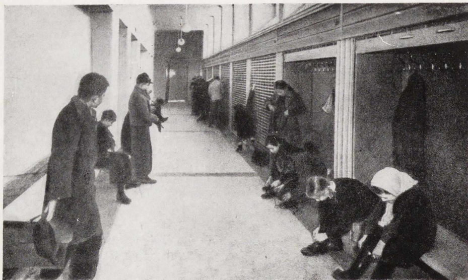
Раздевалка — помещение в полуподвале школы. Ниши с индивидуальными крючками и местом для хранения уличной обуви, закрываются подъемными жалюзи. Ниши вентилируются
